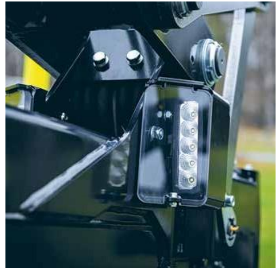
Lumini de lucru cu LED cu sticlă securizată
